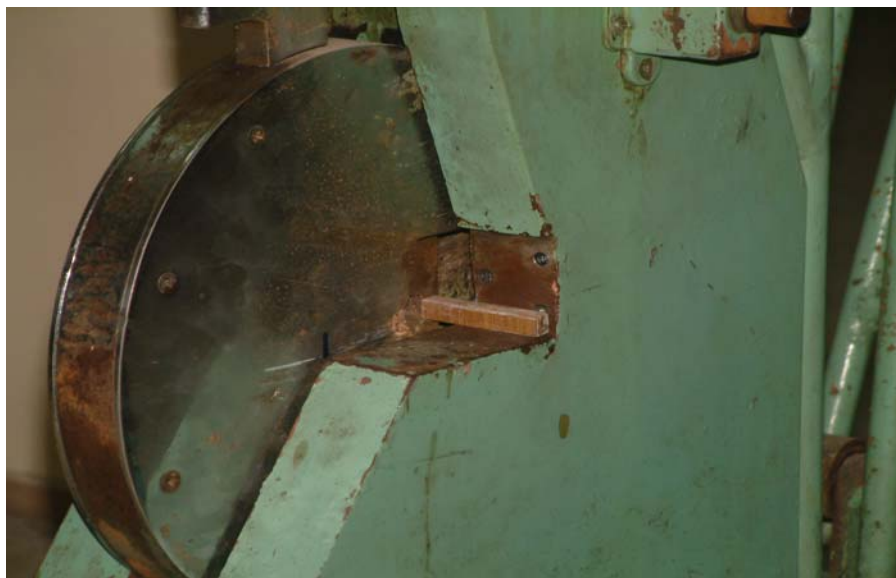
Gambar 8. Pemasangan specimen pada mesin uji impact
