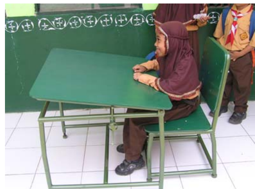
Gambar 5.15 Prototype Meja dan Bangku Ergonomis Pemakaian di MI Miftahul Ulum Batu Untuk Murid Perempuan, bangku tanpa busa/ foam
