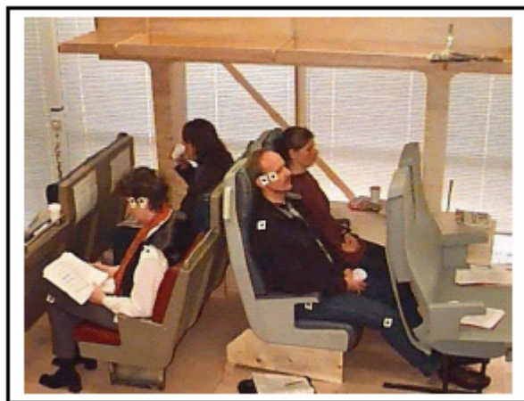
Gambar 2.1. Penelitian Tentang Kursi Ergonomis Dalam Kereta Api Gambar kiri adalah kondisi tidak Ergonomis tanpa sandaran kepala dan gambar kanan Kursi ergonomis dengan sandaran kepala, tulang belakang serta posisi kaki yang rileks
