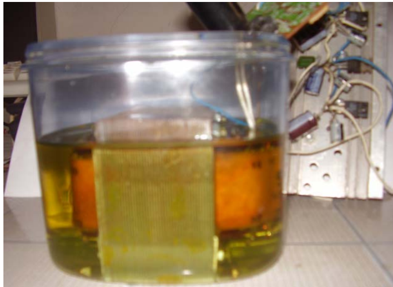
Gambar 8. Transformator di Rendam Pada Minyak Pendingin.
