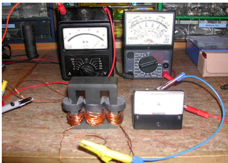
Gambar 6. Pengujian Tahanan Isolasi Kumparan Primer
