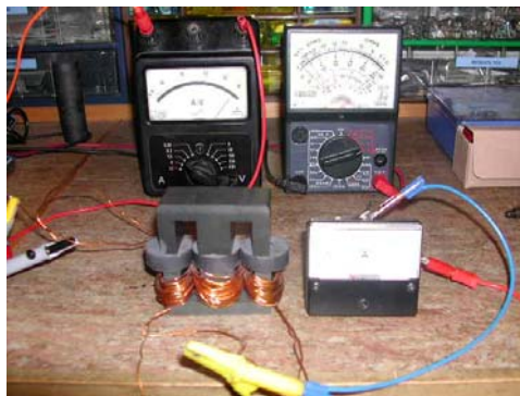
Gambar 4. Pengukuran Arus dan Tegangan
